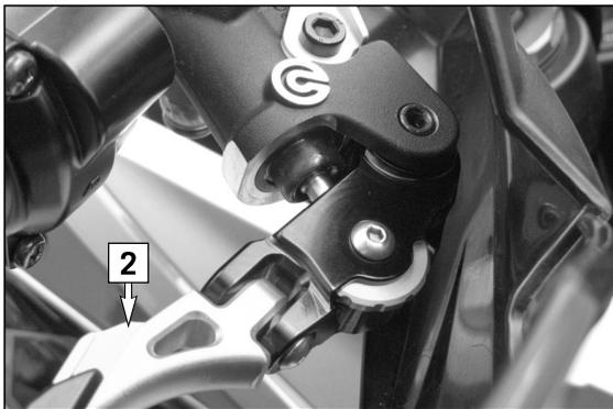
Handbremshebel (2) mit der Original-Schraube und Original-Mutter montieren.
